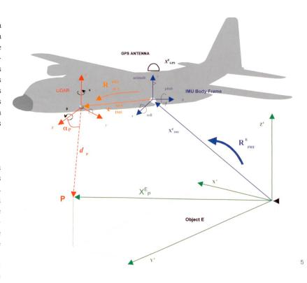
5 Illustration du géoréférencement d'une mesure LiDAR cinématique (aérien). E représente le système de coordonnées objet (par ex. système national). Le point P, mesuré par le LiDAR, est exprimé en fonction des mesures des différents capteurs (centrale inertielle et LiDAR
