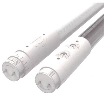
Parmi les solutions d'économie d'énergie, le tube LED est de plus en plus appelé à remplacer les anciens tubes fluorescents. Ils sont faciles à installer: il suffit généralement de changer l'ancien tube et de remplacer le starter par un starter «LED» et le tour est joué. L'ancien luminaire qui consommait 36W n'en consommera désormais plus que 18W. Sachant que les tubes fluorescents équipent majoritairement les communs d'immeubles, les garages, couloirs et autres passages éclairés
