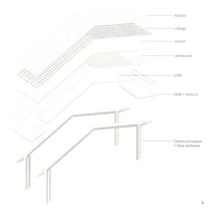
une grande partie des efforts. Le solde des efforts est introduit par des tiges filetées forées et liées avec une résine époxy dans la partie centrale du cadre en bois.
