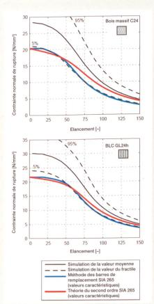
Résultats d'analyse selon la méthode des barres de remplacement ou la théorie du second ordre pour le bois massif C24 (en haut) ou lamellé collé GL 24h (en bas)
