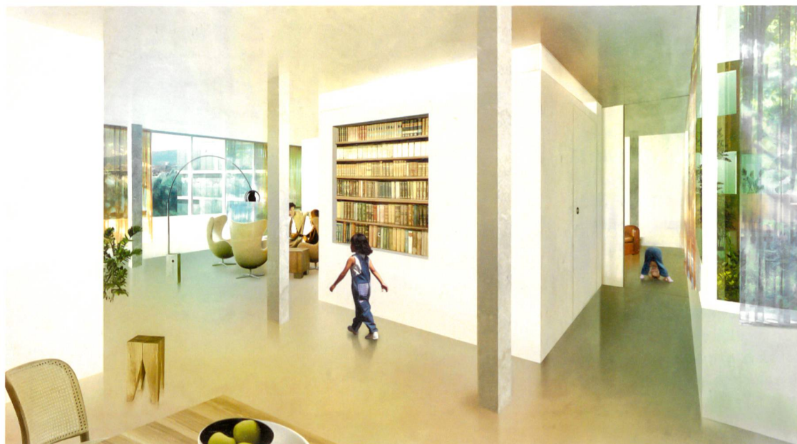
1 La construction en poteaux-dalles permet de proposer des espaces différenciés (perspective de concours d'un espace de séjour)
