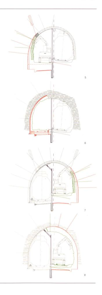
de la roche, il a été décidé de réaliser ces travaux par demi-section. Pour garantir la sécurité de l'exploitation de la ligne ferroviaire et celle des ouvriers travaillant dans le tunnel, une paroi de protection a dû être installée entre les deux voies dans le tunnel.
