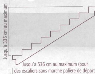
Les escaliers préfabriqués RATIONAL® sont conçus pour une hauteur d'étage allant jusqu'à 335 cm.
