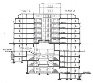
Abb. 2. Ouerschnitt durch Kino-Eingang und -Treppenhaus. - 1:600.
