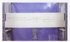
Fissuration d'une poutre: rupture en traction perpendiculaire d'un assemblage transversale avec des broches sollicitées perpendiculairement au fil – banc d'essais et éprouvette de l'EPF Zurich. (Photo Robert Jockwer, IBK de l'EPFZ)
