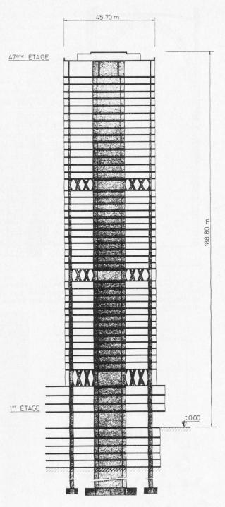
Fig. 25. — Tour place Victoria, Montréal 1967. Elévation. Remarquer les liaisons entre les parois et les piliers d'angle au niveau des étages techniques afin de diminuer les déformations par effet de béquille.
