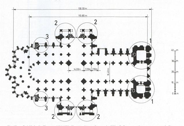
Fig. 15. — Cathédrale de Chartres, 1194-1220. Vue en plan, surface totale 6038 m². Remarquer les poteaux, en particulier à la croisée du transept et les « tours de blocage » pour la stabilité générale :
