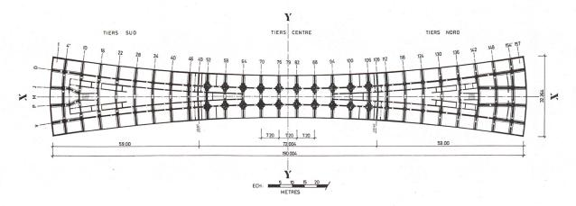
Fig. 32. — Nouveau siège du Bureau International du Travail, Genève 1972. Vue en plan de l'étage technique, traverse des cadres. Structure alvéolée partiellement précontrainte.
