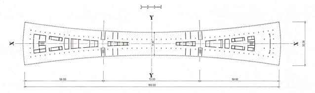
Fig. 31. — Nouveau siège du Bureau International du Travail, Genève 1972. Vue en plan de l'étage courant. Structure avec parois et noyaux. Longueur 190 m divisée en trois parties de 59 + 72 + 59 m par deux joints de dilatation.
