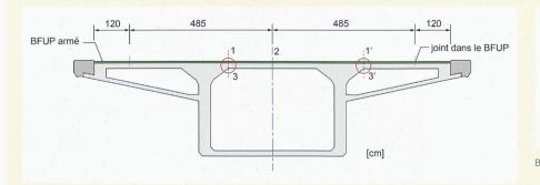
A Viaduc de Chillon avec la dalle de roulement renforcée au moyen du BFUP armé avec indication de la largeur des étapes de coulage du BFUP
