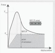
limitée des BFUP doit être considérée lors du dimensionnement par une marge de sécurité adéquate, afin d'exclure un mode de rupture soudain par écrasement du BFUP.
