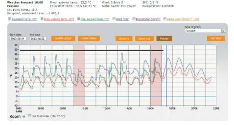
Relevé de températures dans le tableau de bord: température équivalente utilisée par le système de régulation du chauffage, température prévue par la météo et température mesurée sur le site.
