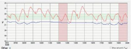
Températures mesurées à l'intérieur d'un bâtiment par deux «Climate loggers»: la courbe en rouge correspond à un appartement situé dans les combles, celle en bleu à un appartement situé au centre de l'immeuble.
