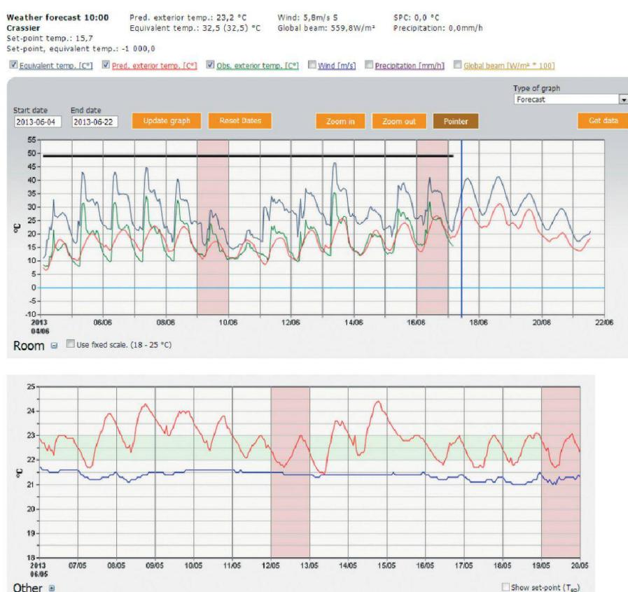
Relevé de températures dans le tableau de bord: température équivalente utilisée par le système de régulation du chauffage, température prévue par la météo et température mesurée sur le site.
