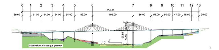
posé d'un tablier en structure mixte acier-béton franchit la vallée de la Sarine au-dessus de la STEP à une hauteur d'environ 70 m. Comme décrit dans un précédent article (lire TRACÉS n° 22/2011), le pont peut être divisé en trois parties distinctes (fig. 2):
