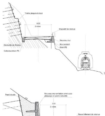
our réaliser le nouveau gabarit routier sur la route cantonale (RC) Bulle — Château-d'Œx, il a fallu élargir la plateforme de 3 m environ dans des talus déjà à forte pente, de manière à mettre également en œuvre une gondole d'évacuation des eaux. L'exiguïté de la plateforme existante et la nécessité d'assurer en tout temps la circulation sur la RC sur une voie au minimum constituaient les principales contraintes du projet.
