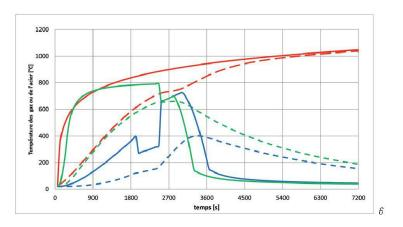
Elle a d'abord conduit à l'utilisation d'actions thermiques plus favorables par la définition de plusieurs scénarios de feux naturels <sup>4</sup> (fig. 6) et par la détermination des températures des gaz, obtenues par calcul informatique dans un modèle de zones <sup>5</sup>.
