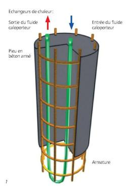
En matière de production de chaleur, il est possible d'extraire de 20 à 100 W par mètre de pieu, des valeurs qui varient en fonction des propriétés du sol, de la géométrie de la fondation et des conditions d'exploitation du système. A titre d'exemple, une sonde géothermique peut produire à long terme entre 75 et 150 kWh/m par an [2].
