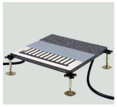
Lenzlinger propose désormais une autre façon de chauffer ou de climatiser des locaux de bureaux, à partir d'un faux-plancher en bois aggloméré ou en sulfate de calcium. A l'intérieur du panneau se cache une partie active, et qui est reliée à la centrale de froid/chaud du bâtiment et qui permet ainsi de le chauffer ou climatiser.
