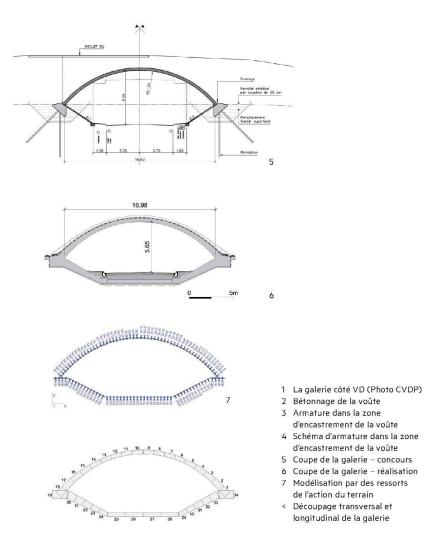
qui correspondent à ceux fournis par modèle géotechnique 3D. Ce troisième modèle de calcul (C) permet de dimensionner les armatures pour l'état limite ultime et de définir les efforts intérieurs qui sollicitent chaque partie de la structure à l'état de service.
