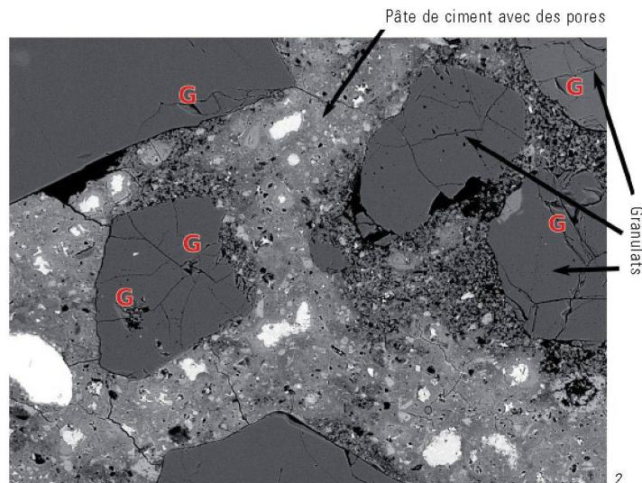
Fig. 3: Texture de béton (Photo DR)
