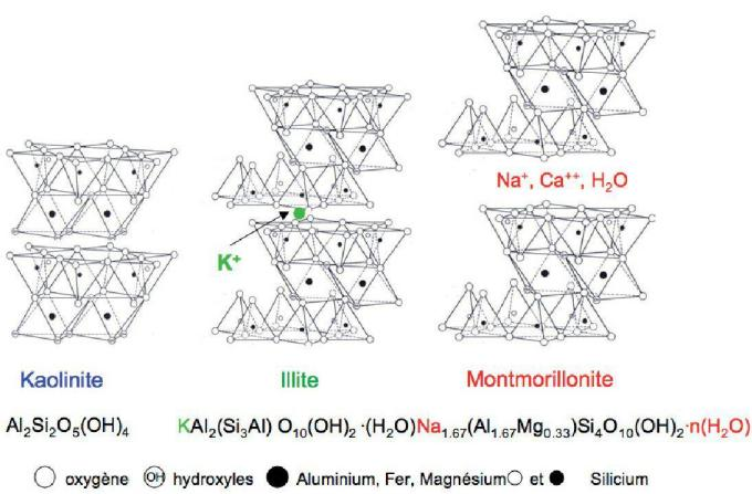
ou activation thermique, les cristaux d'argiles seraient dans un état trop stable qui empêcherait toute réaction avec l'hydroxyde de calcium provenant du ciment.
