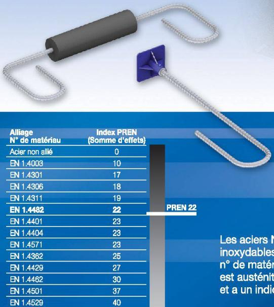
Les aciers NIRO22 sont des aciers inoxydables nervurés possédant le n° de matériau EN 1.4482. NIRO22 est austénitique-ferritique (Duplex) et a un indice PREN de 22.
