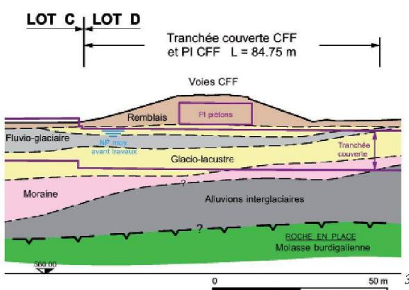
La réalisation de la fouille de la TC CFF implique un abaissement significatif de la nappe (plusieurs mètres) avec l'objectif de dénoyer la nappe libre du fluvioglaciaire. Ce rabattement, prévu à l'aide de puits filtrants situés à l'extérieur de la tranchée, vise à diminuer les venues d'eau, à stabiliser le terrain entre les pieux des parois de fouille et à supprimer le risque de renard hydraulique (instabilité du fond de fouille sous l'effet de forces de percolation).
