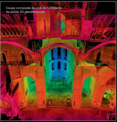
Les technologies de mesure par laserométrie 3D sont parfaitement adaptées aux relevés d'architecture dont les structures sont souvent complexes et difficilement accessibles.
