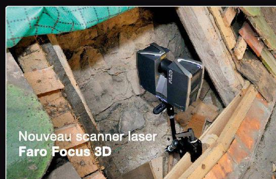
Le scanner Faro Focus 3D est le plus petit et le plus rapide du marché. Il numérise également avec des couleurs réelles exactes. Très léger, muni d'un bras articulé, il peut être placé dans des espaces où aucun autre instrument ne peut être positionné.
