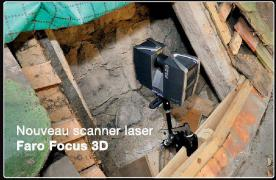
Le scanner Faro Focus 3D est le plus petit et le plus rapide du marché. Il numérise également avec des couleurs réelles exactes. Très léger, muni d'un bras articulé, il peut être placé dans des espaces où aucun autre instrument ne neut être positionné
