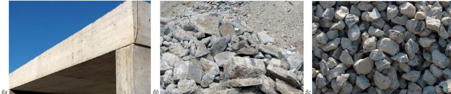
que de la recette existante, en jouant notamment sur le type de ciment utilisé, et ensuite sur la proportion de granulats recyclés et l'analyse systématique des propriétés telles que la consistance, la résistance en compression et en traction, la durabilité, le module d'élasticité, le fluage et le retrait. Cette démarche prenait évidemment en compte les granulats recyclés produits sur place et les possibilités logistiques de la centrale, en particulier en ce qui concerne les silos à ciments.
