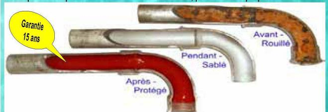
► Nettoyage mécanique par sablage, propre, rapide, économique et écologique.
