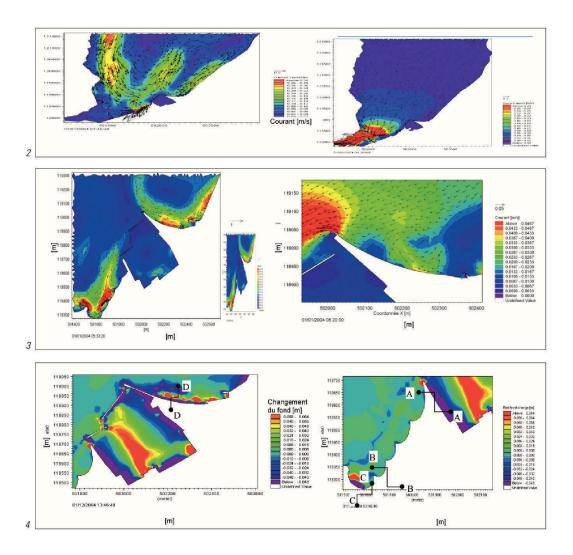
mations. Il y a tout d'abord la réfraction, qui tend à rendre les vagues parallèles aux courbes de niveaux sous l'influence de la proximité du fond. Il y a ensuite la diffraction, qui provoque une rotation des crêtes et une réduction de l'amplitude de la houle autour des obstacles tels que les musoirs de digues.
