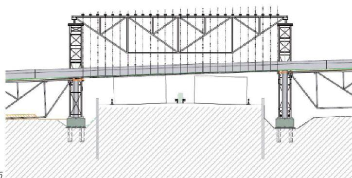
Après la prise du béton et la mise en précontrainte de la travée, le tablier devait être suspendu avec des câbles à deux portiques placés au droit des piles, pour être ensuite abaissé dans sa position définitive (fig. 4). Les piles devaient être bétonnées sur des socles avant l'abaissement du tablier et être fixées à ce dernier; la liaison après abaissement aurait été faite directement dans la semelle de fondation.
