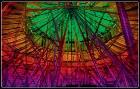
Les technologies de mesure par laserométrie 3D sont parfaitement adaptées aux relevés d'architecture hôtelière somptueuse très décorée et de structures enchevêtrées.
