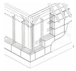
murs dû au poids qu'on leur ajoute est anticipé par un système de sangles de précontrainte. Cette technique permet de réaliser des murs avec des petites ou des grosses bottes, qui atteignent le standard Minergie-P, soit une consommation de chauffage quasiment nulle.
