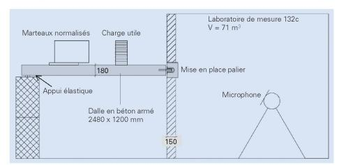
Figure 3: Affaiblissement du bruit de choc pondéré A par les éléments CRET Silent-980, CRET Silent-960 et CRET Silent-970 avec charge utile par rapport à un palier mis en place de manière fixe
