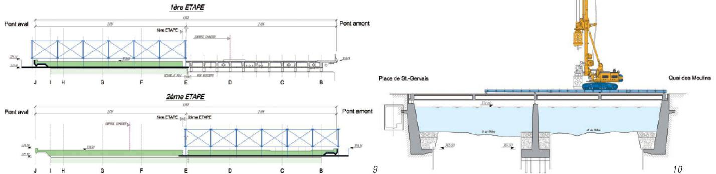
de capacité, espacés d'environ un mètre. La pile centrale, quant à elle, sera démolie et reconstruite ; elle reposera sur de nouvelles fondations profondes constituées de 24 pieux en béton de 90 cm de diamètre. Les pieux et micropieux, qui ont une longueur de 25 à 35 m, sont fichés dans la couche inférieure de moraine wurmienne consolidée.
