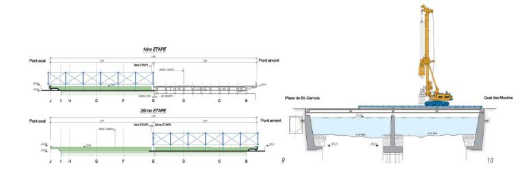
de capacité, espacés d'environ un mètre. La pile centrale, quant à elle, sera démolie et reconstruite; elle reposera sur de nouvelles fondations profondes constituées de 24 pieux en béton de 90 cm de diamètre. Les pieux et micropieux, qui ont une longueur de 25 à 35 m, sont fichés dans la couche inférieure de moraine wurmienne consolidée.
