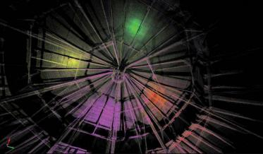
Relevé laserométrique d'une charpente en métal et en bois, réalisé avec le scanner Faro Photon. Une mise en géoréférence automatisée de millions de points 3D inégalée à ce jour. Faro Photon est actuellement l'un des scanners les plus performants du marché. Il mesure rapidement l'intégralité de l'espace dans lequel il est placé (360° par 340°), résolution max. de 1 mm à 50 m et précision de +/- 2 mm à 25 m.
