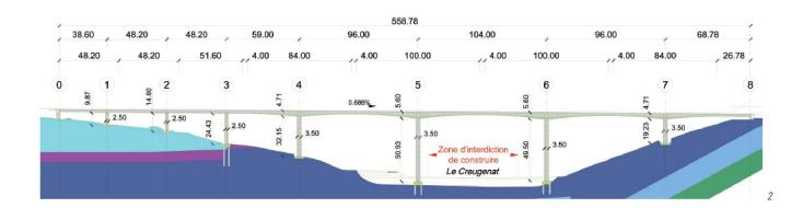
la travée de rive Est d'une longueur respective de 26.8 et 12.5 m pour les viaducs Nord et Sud, réalisée également sur cintre fixe.
