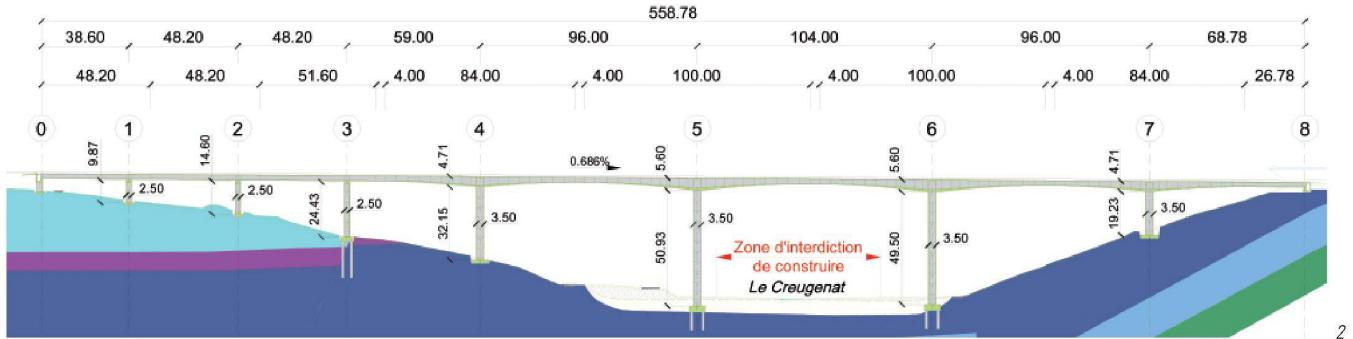
– la travée de rive Est d'une longueur respective de 26.8 et 12.5 m pour les viaducs Nord et Sud, réalisée également sur cintre fixe.
