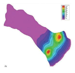
1993 et le 31 décembre 1995. Une fois la calibration des paramètres obtenue, l'efficacité du drainage a été évaluée en ajoutant les drains dans les modèles. Une modélisation détaillée de la zone des drains a permis d'optimiser leur espacement à environ dix mètres.
