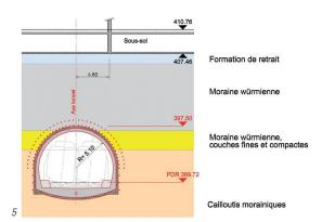
du front de taille avec des boulons en plastique armé de fibre de verre. L'application du béton projeté peut aussi participer au maintien de la stabilité du front de taille. En présence de terrain très plastique dans la voûte, il est prévu de réaliser du *Jet-Grouting* (jetting) entre les tubes de la voûte parapluie comme mesure constructive subsidiaire. Cette façon de procéder améliore non seulement le comportement du terrain, mais accroît également la rigidité de la voûte parapluie.
