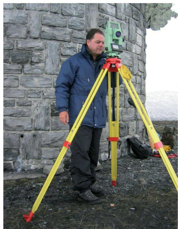
*Fig. 7 : Implantation au théodolite, prisme au point à piquer
