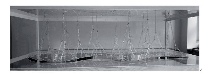
permanentes (essentiellement le poids de la toiture). D'un point de vue statique, cela se traduit par le fait que chaque structure « arbre » est l'image d'une composition vectorielle des forces ciruculant de la toiture vers les fondations.
