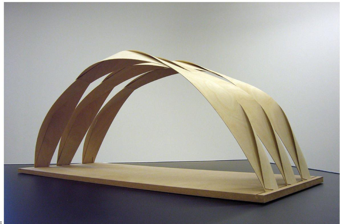
Fig. 7: Des maquettes faites à partir de bandes de carton ou de planches fines en sapin sont assemblées en utilisant la technique du tressage. Des contre-courbures peuvent être introduites en manipulant les planches.
