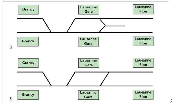
les trains de la petite boucle. En revanche, pour le carrousel 3/6 min, il est possible d'inverser les trains de la petite boucle sur la voie unique, ce qui autorise l'utilisation des deux quais à la Gare pour les trains de la petite boucle, un schéma nettement préférable pour les échanges passagers en station (fig. 3).
