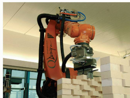
Robot maçon (Photo Gramazio et Kohler, Architecture et fabrication numérique, ETHZ)
