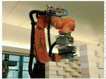
Robot maçon (Phot abrication numéric
