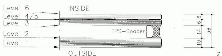
Fig. 3a : Détail joint « Vario » - Façades périphériques
