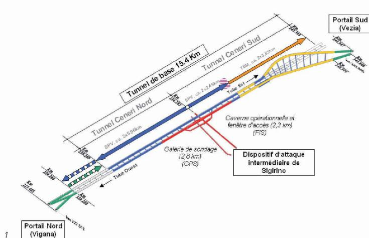
Fig. 1 : Schéma général du tunnel et principe de creusement à partir du dispositif d'attaque intermédiaire
