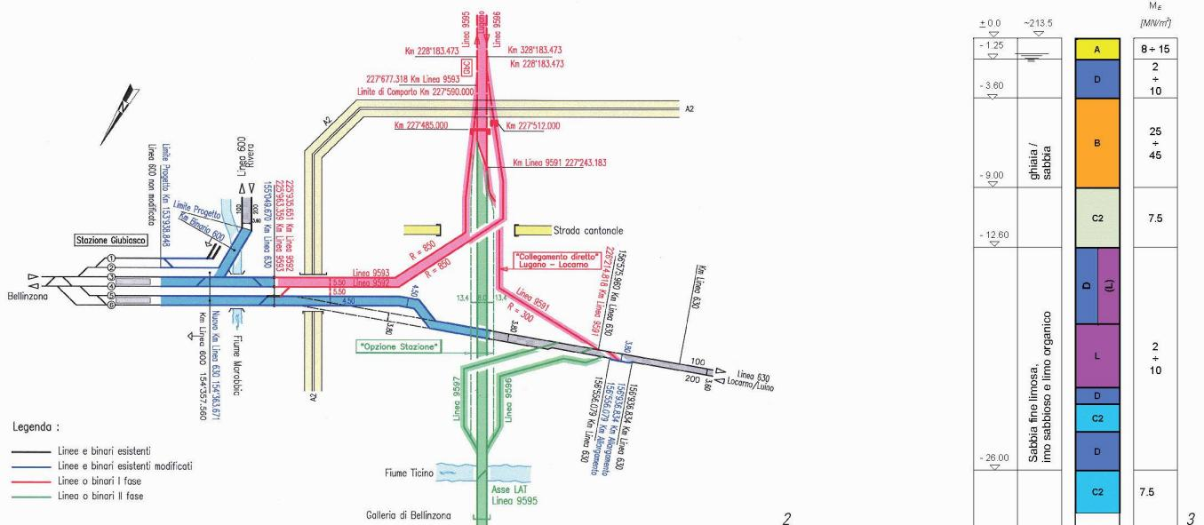
s'étendront sur quelque 100 m de part et d'autre de la voie et devraient atteindre jusqu'à 80 cm au centre du remblai. Pour anticiper ce phénomène, le remblai sera construit près de trois ans avant les différents ouvrages, avec un supplément d'environ 2 m de matériaux pour créer une précharge des sols de fondation.
