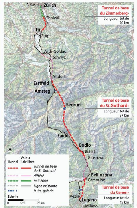
Fig. 1: Tracé général de la ligne de base du St-Gothard
