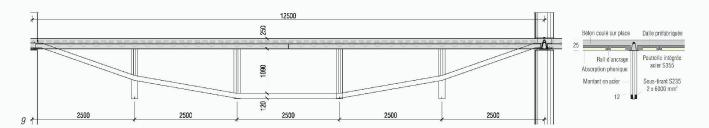
En ce qui concerne le projet réalisé, la quantité d'acier de charpente s'élève à environ 80 kg/m², ceci pour des planchers soumis à des contraintes très sévères. Compte tenu que seuls quatre montants demeurent dans l'espace entre le tirant et la dalle, la partie centrale du système est pour ainsi dire « vidée de sa matière ».
