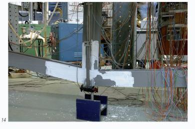
déchargement complet (fig. 12). A noter encore que, lors des deux chargements à la ruine, les déformations ont augmenté jusqu'à plus de 100 mm (limite de course des vérins du banc d'essai). A partir de quelque 90 mm, les déplacements verticaux ont continué à augmenter sans aucune élévation de la charge, prouvant que la limite de portance de la structure avait réellement été atteinte.
