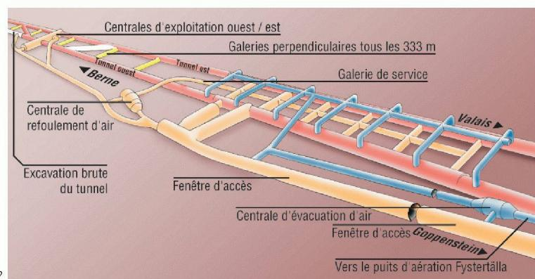
Fig. 1 : Aperçu schématique du tunnel de base du Lötschberg
