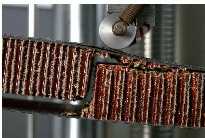
Fig. 1 : La structure « sandwich » de la coque : deux couches de fibres de carbone et de résine enveloppent un nid d'abeilles
