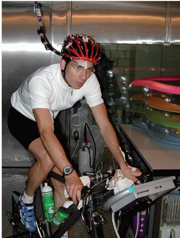
Fig. 1 : Essai au porter pour mesurer l'efficacité d'évaporation d'un prototype de vêtement
