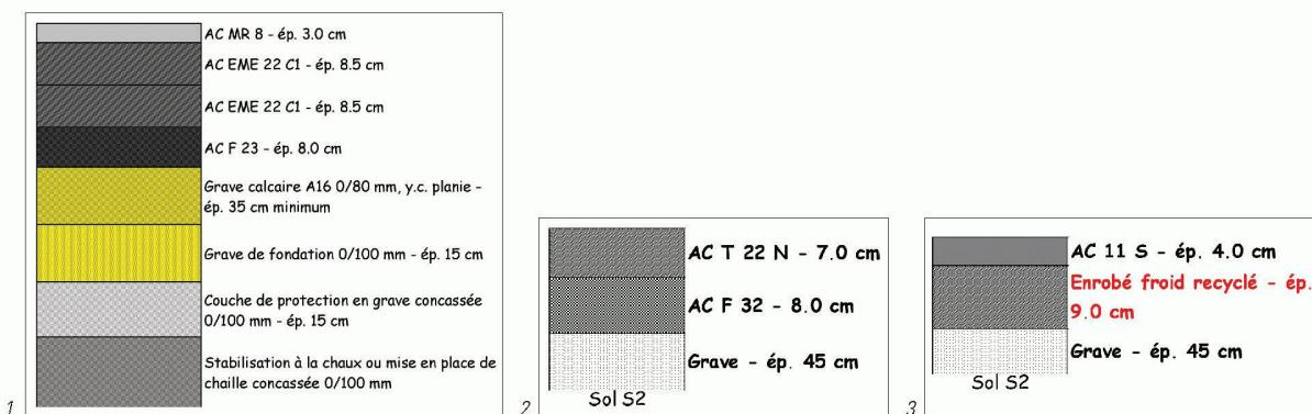
Chevez. Cette variante consistait à remplacer une partie des enrobés à chaud prévus par un enrobé à froid fabriqué avec 100% de granulats d'asphalte recyclé. En outre, une optimisation du dimensionnement par la méthode SETRA-LCPC a permis de réduire de deux centimètres de l'épaisseur des couches liées (fig. 2 et 3).
